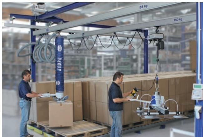
Алюминиевая крановая система с одной балкой, грузоподъёмность 85 или 150 кг, рабочая зона 2x6 м или 4x6 м
