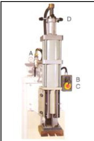
і Цилиндр со стержнем призматического сечения из термообработанной стали и с роликовыми направляющими
