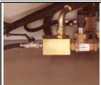
І Клапан для остановки подачи воды при отключении машины
