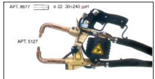
Smart gun: Клещи пневматические с водяным охлаждением. Возможность использования: стандартные плечи и плечи с большим раствором Арт. 5127...5137.
