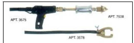
Пистолет многофункциональный для приварки винтов, шпилек, шайб, заклепок и односточечной сварки, с электродом, предназначенным для рихтовки. Ударная насадка (обратный молоток). Зажим с кабелем.
